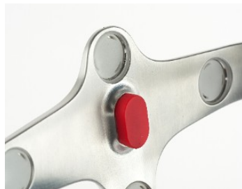
A házakban lévő reflektív marker elhelyezésének illusztrálása a frontális nyomkövetőn.
